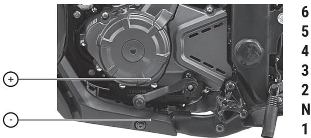
1. Con el motor en ralentí, apriete la manija del embrague y pise el pedal de cambio para poner la marcha en 1ª posición.
